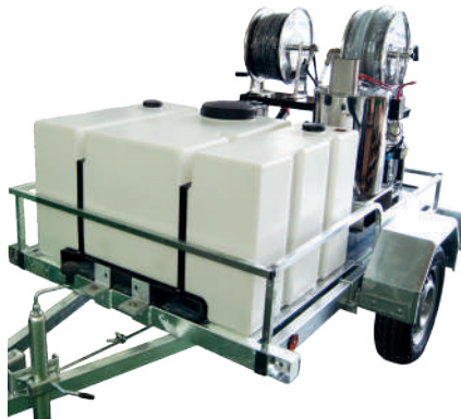
• Depósito rotomoldeo de 400 litros con tres puntos de relleno.
