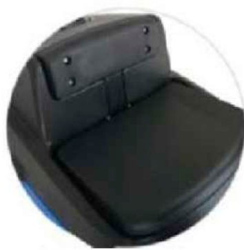
Sistema de detección de presión en el asiento para evitar tocar falsamente el pedal de manejo, lo que podría crear un accidente.
