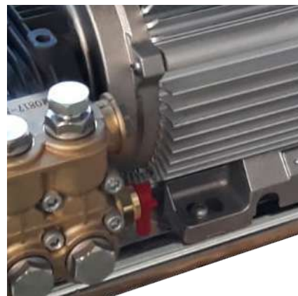
• Válvula térmica para proteger las bombas de las altas temperaturas.
